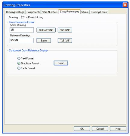
چنانچه تجهیزاتی که با هم مرتبط می باشند (مانند کویل یک رلهٔ کمکی و کنتاکت مربوط به آن) در یک صفحه باشند، فقط آدرس آن ناحیه مشخص میشود که N% بیانگر آن میباشد. ولی چنانچه تجهیزات مرتبط، در دو صفحهٔ مختلف باشند، قبل از آدرس ناحیه ، شماره صفحه ذکر میگردد که S% بیانگر آن میباشد.
