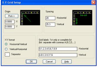
در این پنجره باید تنظیمات مربوط به نقطهٔ شروع آدرس دهی ، گامهای افقی و عمودی، نوع جداسازی بین آدرس افقی و عمودی و نحوهٔ نامگذاری گامهای افقی و عمودی مشخص شوند. -در نهایت در پنجرهٔ Drawing Properties در بخش Tag/Wire Number Order نحوهٔ شماره گذاری سیم و تجهیزات انجام میشود.
