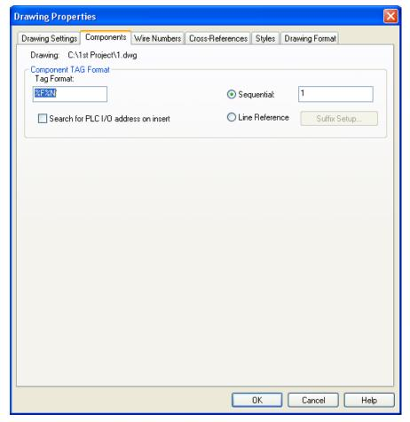
در سربرگ سوم: نحوهٔ شماره گذاری سیم ها و محل قرار گیری آنها مشخص می شود. N% بیانگر شماره میباشد. دو انتخاب Sequential و Line Reference در دسترس میباشد که چنانچه نقشه کشی جهت PLC باشد از گزینهٔ Reference و چنانچه جهت نقشه های اسکماتیک باشد از گزینهٔ Sequential استفاده می کنیم.
