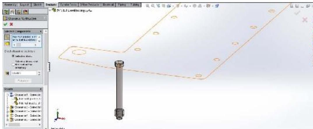
تصویر شماره ۲۱: بررسی لقی بین قطعات بصورت جفت جفت در قسمت Results
