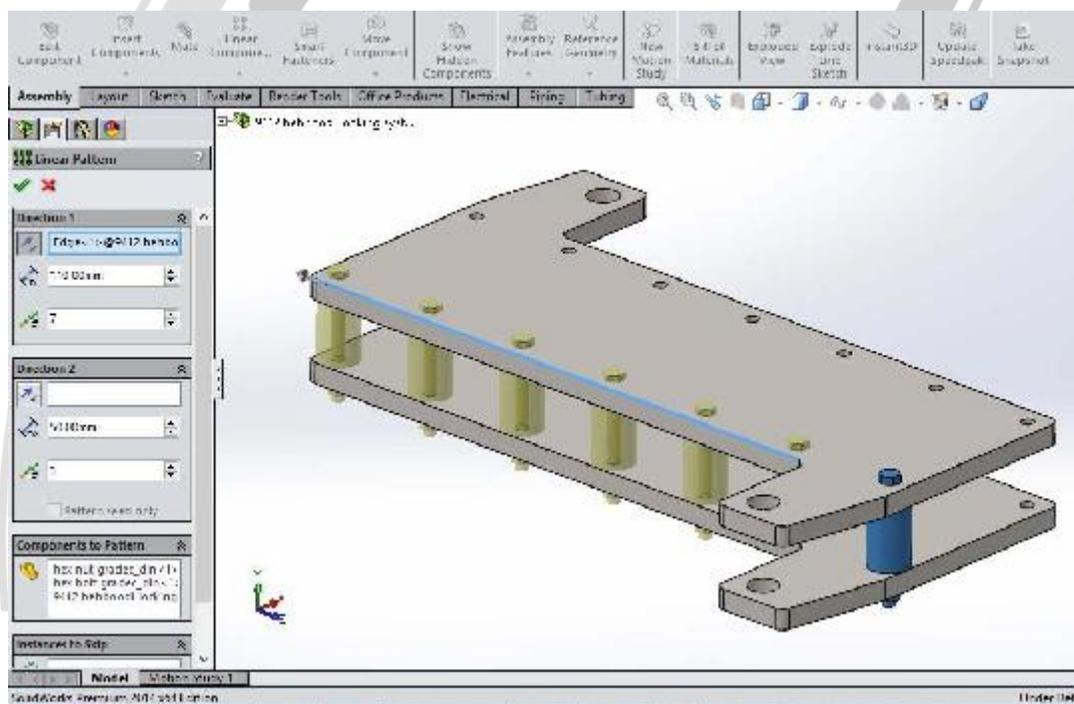
تصویر شماره ۱۱ : دستور Linear component pattern در محیط اسمبلی
