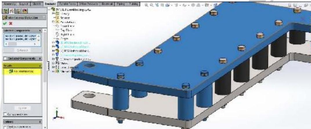
تصویر شماره ۱۹: محاسبه تداخل قطعات در بخش **Interference Detection**
