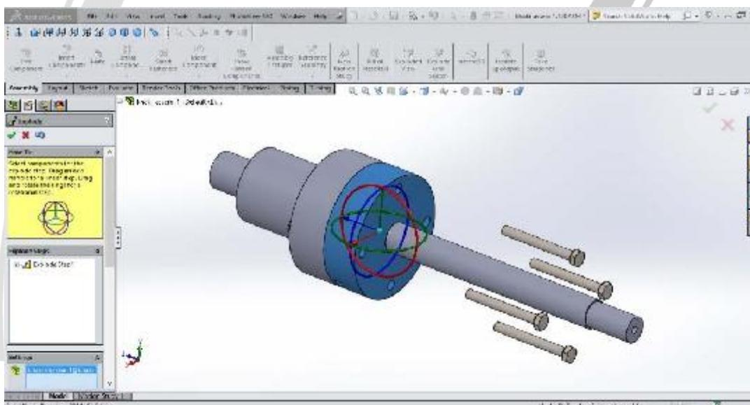
تصویر شماره ۲۳: جابجایی قطعات در دستور **Exploded view**
