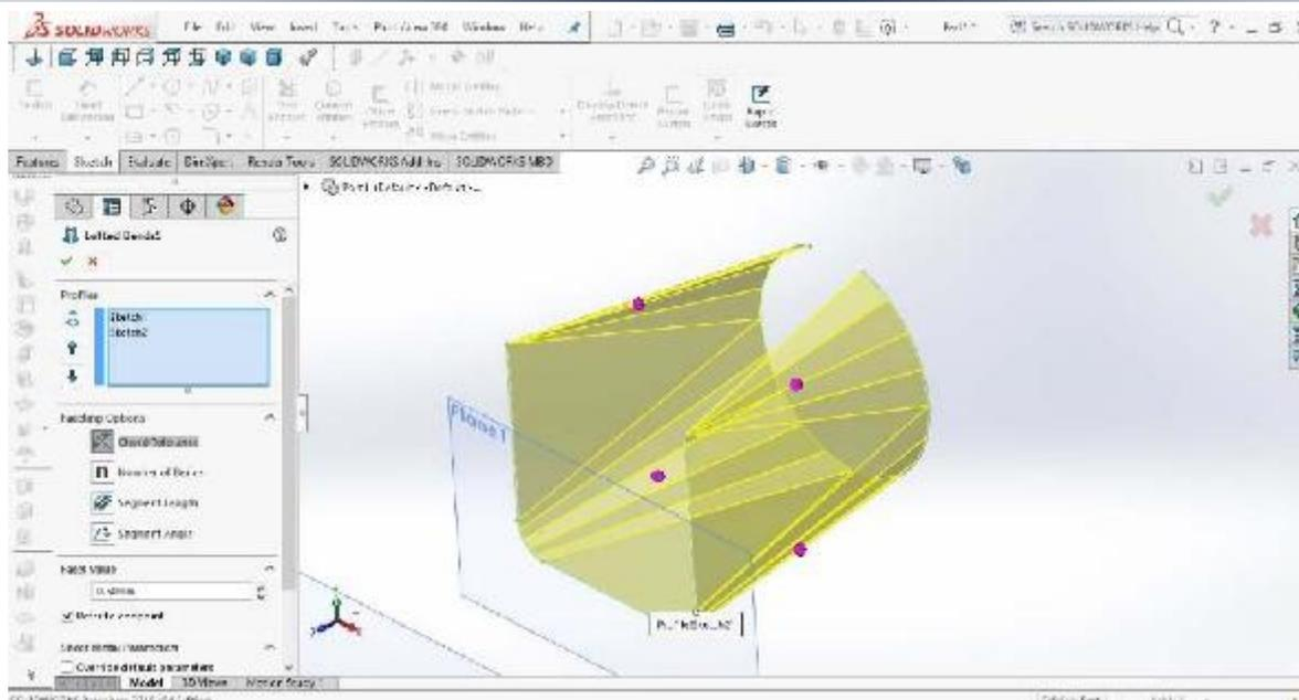
تصویر شماره ۶: ایجاد قطعه ورق کاری با استفاده از دستور Loft در محیط ورق کاری سالیدورک
