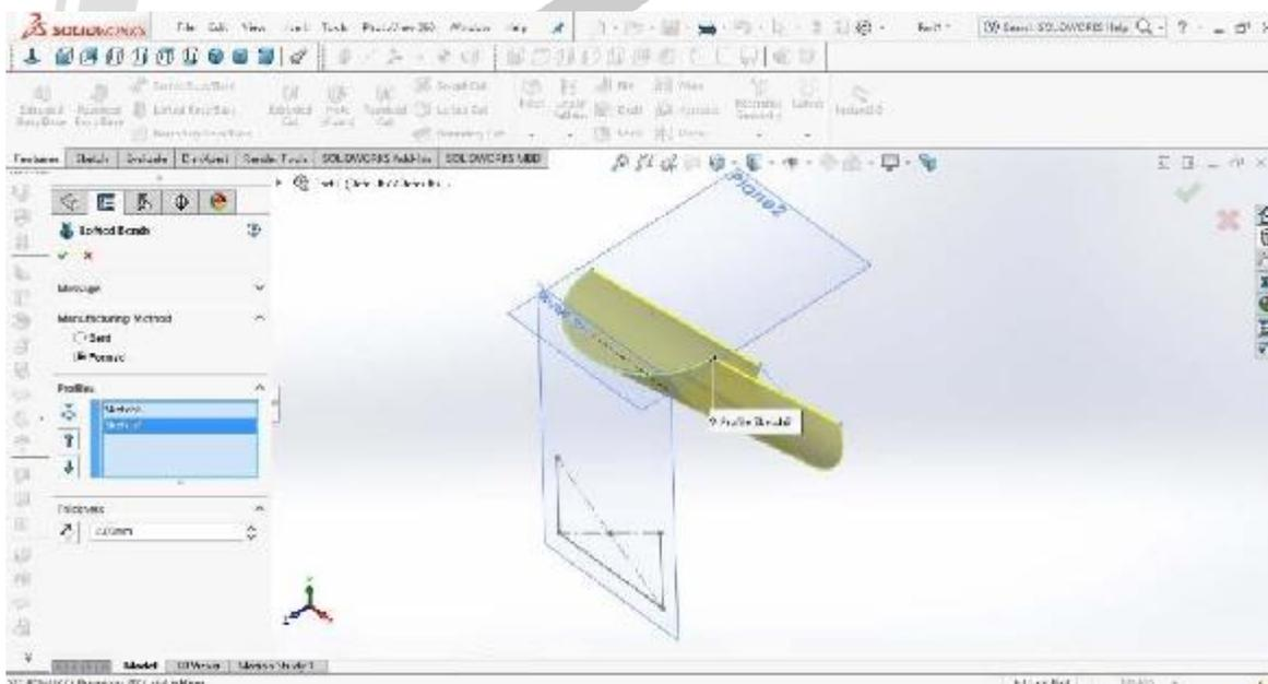
تصویر شماره ۷: ایجاد قطعه ورق کاری با استفاده از دستور Loft و شیوه ساخت فرم دهی در محیط ورق کاری سالیدورک
