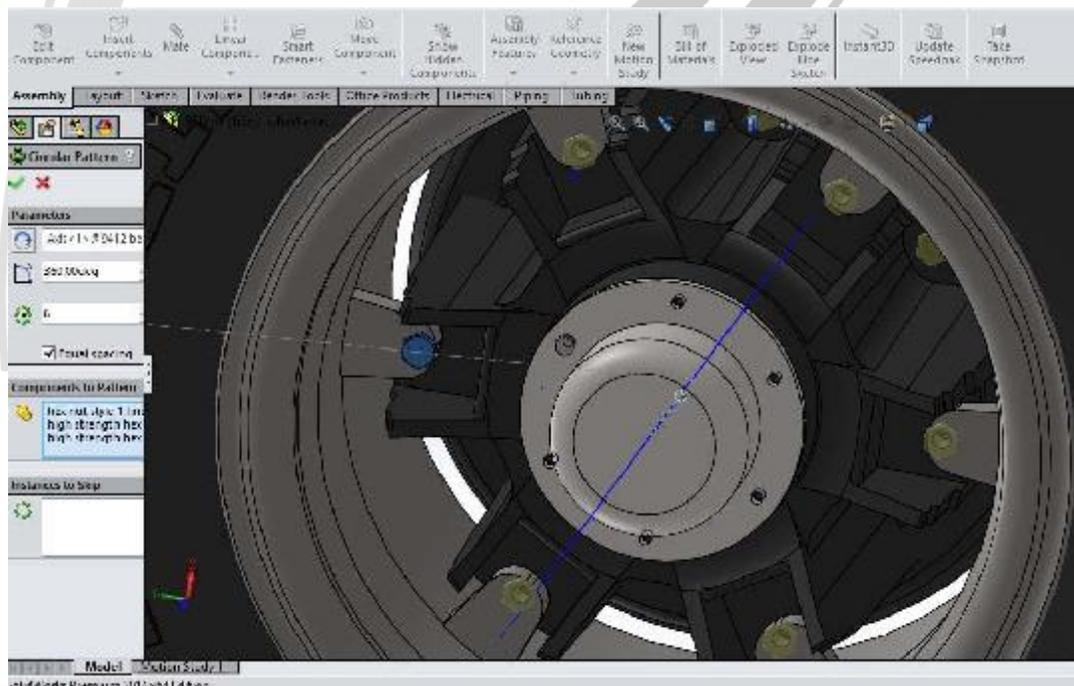
تصویر شماره ۱۰: دستور **Circular component pattern** در محیط اسمبلی
