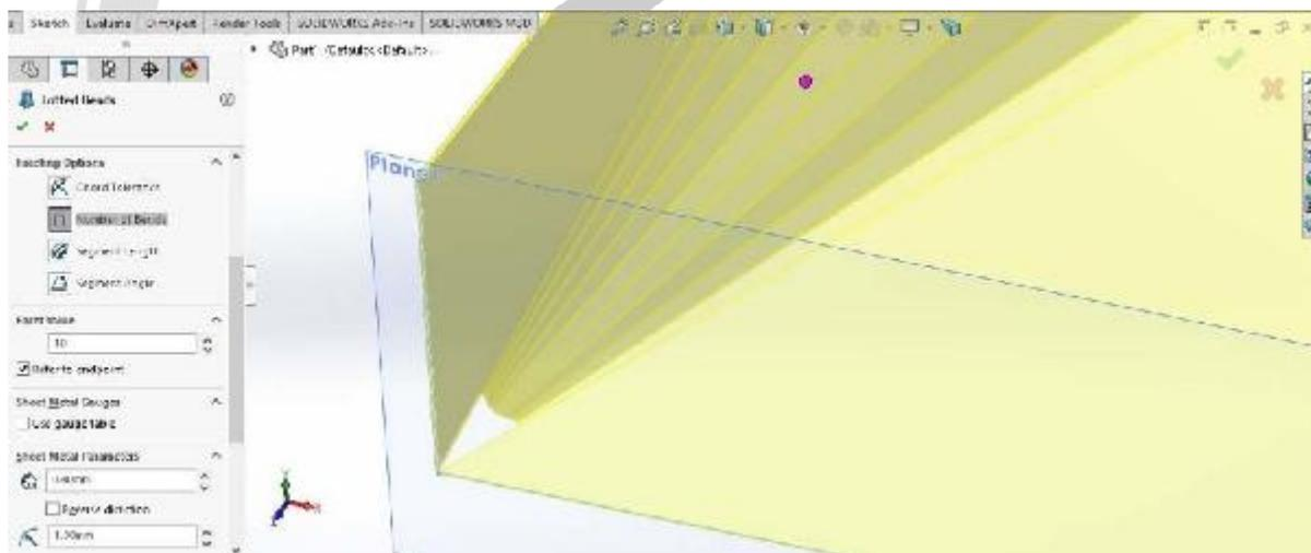
تصویر شماره ۱۲: شکل بدست آمده با گزینه **Refer To End Point** - به لبه های نیز دقت کنید.
