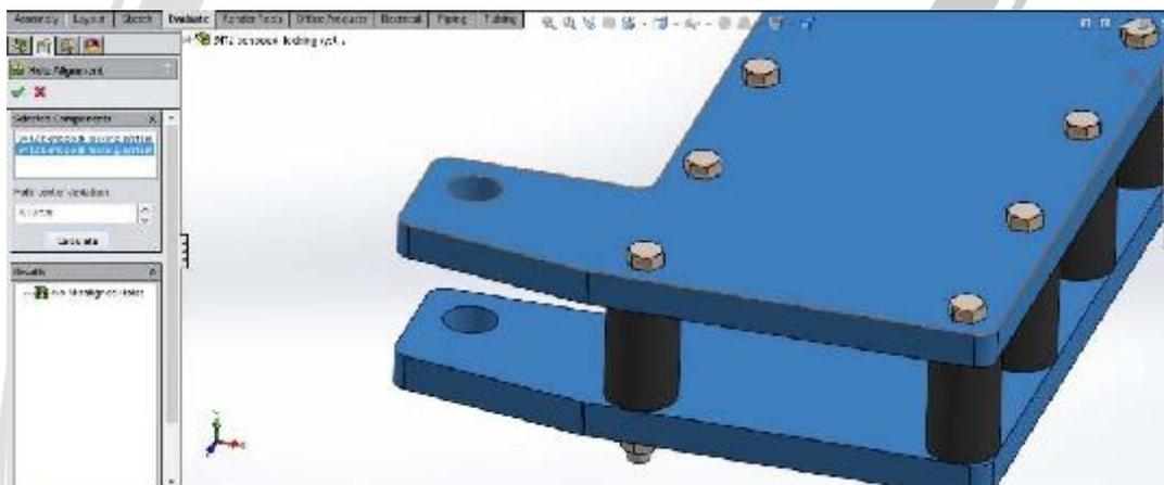
تصویر شماره ۲۲: اجرای دستور **Hole Alignment**
