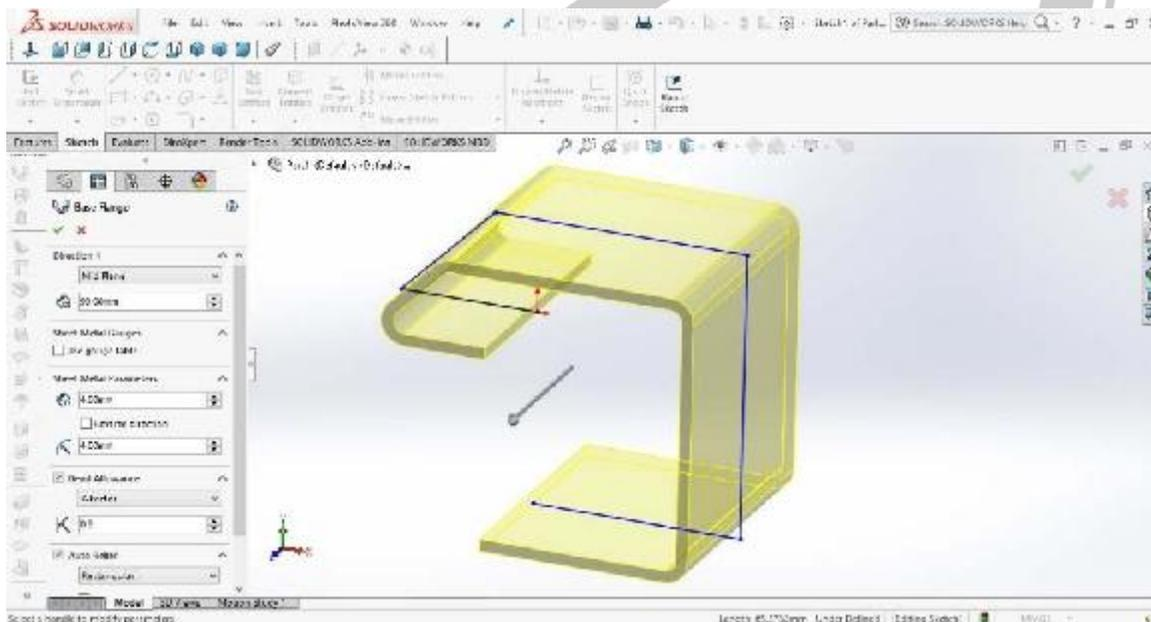
تصویر شماره ۵: ایجاد قطعه ورق کاری با استفاده از **Base Flange** در حالت اسکچ باز
