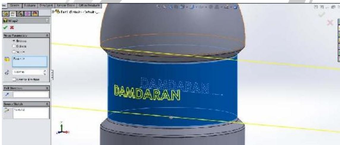
تصویر شماره ۱: دستور Wrap و آپشن های مختلف آن
