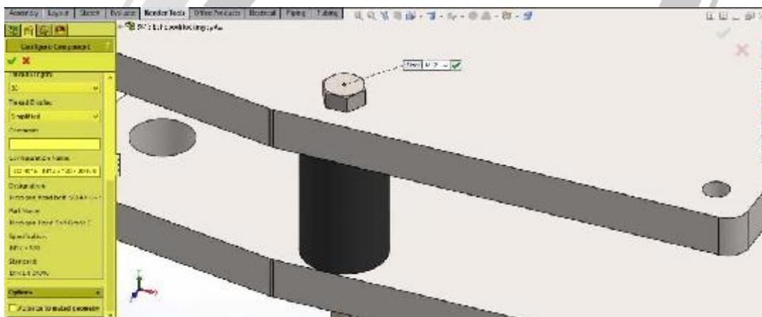
تصویر شماره ۱۶: تعیین مشخصات قطعه استاندارد از طریق پنجره **Configure component**
