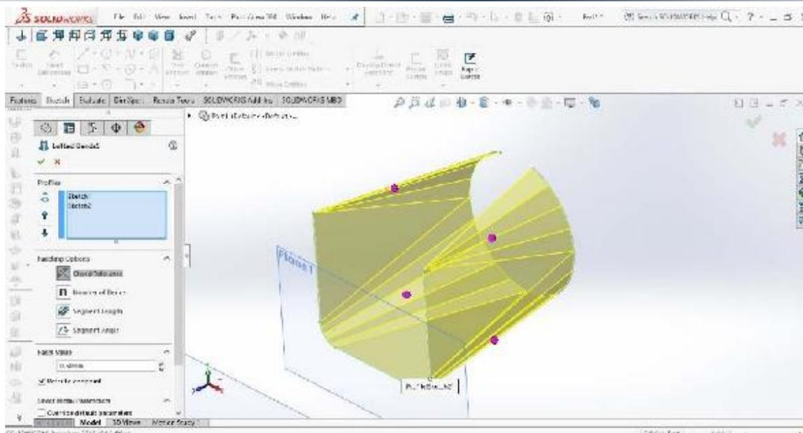
تصویر شماره ۸: ایجاد قطعه با استفاده از دستور Loft و روش خم کاری در محیط ورق کاری سالیدورک
